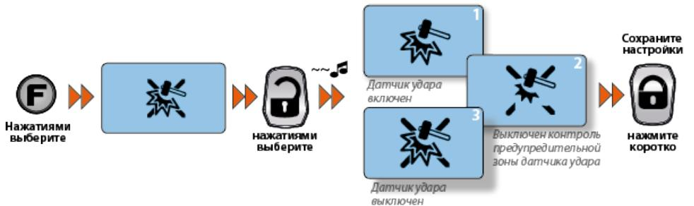
**Настройка режима контроля двухзонного дополнительного датчика** Данная функция предоставляет возможность, при необходимости, отключать предупредительный или тревожный уровень дополнительного датчика. Последовательными нажатиями кнопки **F** выберите пиктограмму , короткими нажатиями кнопки выберите необходимый режим контроля датчика удара и коротко нажмите кнопку для сохранения настроек в базовом блоке.
