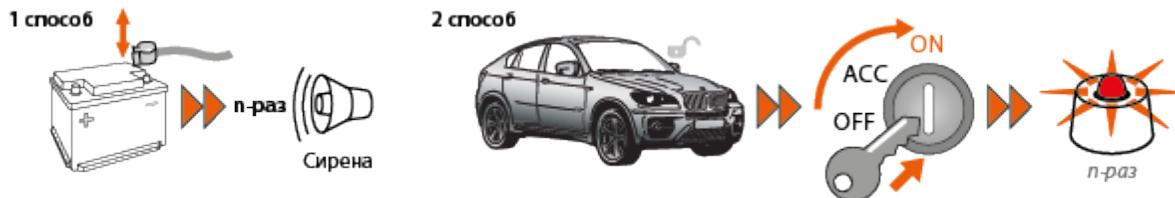
Проверить количество прописанных брелоков в систему можно, сняв и одев обратно клемму аккумулятора, при этом система количеством звуков сирены известит, сколько прописано брелоков. Также проверить количество брелоков можно по количеству оранжевых вспышек индикатора состояния при каждом включении зажигания при выключенном охране.
