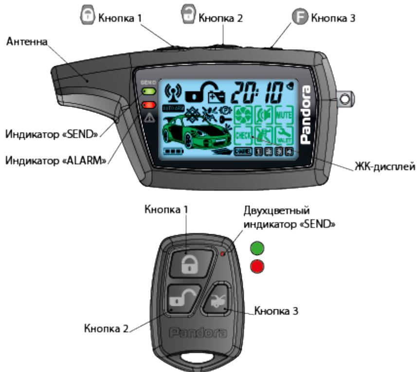
**Индикатор "Send" (зеленого цвета):** *Вспыхивает* - подтверждение наличия связи в канале оповещения (при выключенном зажигании) **Индикатор "Alarm" (Красного цвета)**
